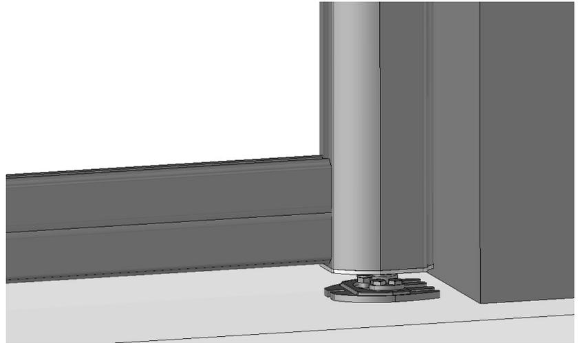
Il est conseillé de coucher le vantail (avec des protections) devant la crapaudine afin de glisser le câble à l'intérieur de la gaine jusqu'à l'armoire de commande.
