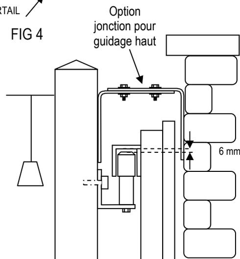
6. Fixer la crapaudine au sol (fixations déterminées et fournies par le poseur). Positionner les 2 équerres montées en forme de U au dessus du portail fixer de part et d'autre (contre plaque à l'intérieur du poteau), puis ajuster l'aplomb.
