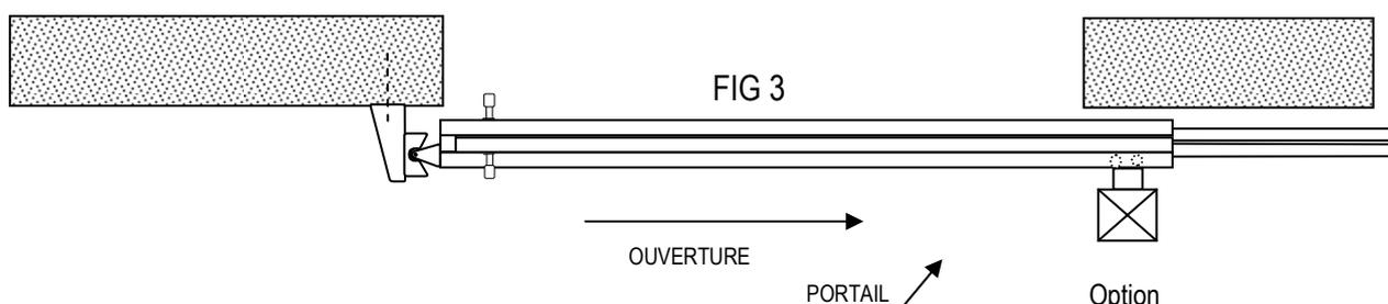
5. Pour le cas d'un montage sans béton (crapaudine + jonction) passer au paragraphe 6. Sceller le poteau d'aplomb (le remplir de béton), tout en laissant entre le galet et le U de guidage au moins 6 mm pour le jeu de fonctionnement (voir FIG 4). Lorsque le scellement est bien sec affiner le réglage des galets.
