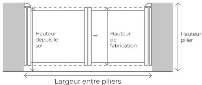
La hauteur maximale de fabrication est égale à la hauteur du pilier diminuée de 100 mm.
