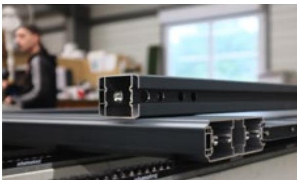
L'assemblage mécanique de précision des portails permet de remplacer seulement la pièce endommagée. Le perçage, les 4 taraudages et les lames vissées accentuent la robustesse des produits. Notre traverse basse, unanimement reconnue, assure une rigidité exceptionnelle supérieure à la plupart des portails du marché.
