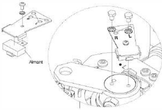
Fixer l'aimant sur la plaque comme indiqué dans le dessin puis monter l'ensemble sur l'arbre de sortie du motoréducteur et individualiser la position en diagonale des trous (R- L) pour la fixation à droite ou à gauche. Fixer les capteurs de fin de course puis les régler en ouverture et fermeture totale.
